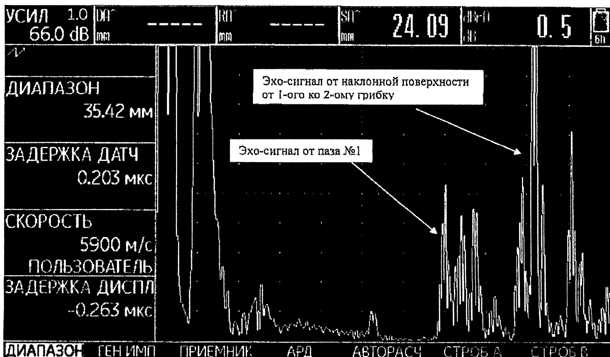
Рисунок 19 – Экран УЗ-дефектоскопа при настройке ПЭП с углом ввода 0° от паза №1
